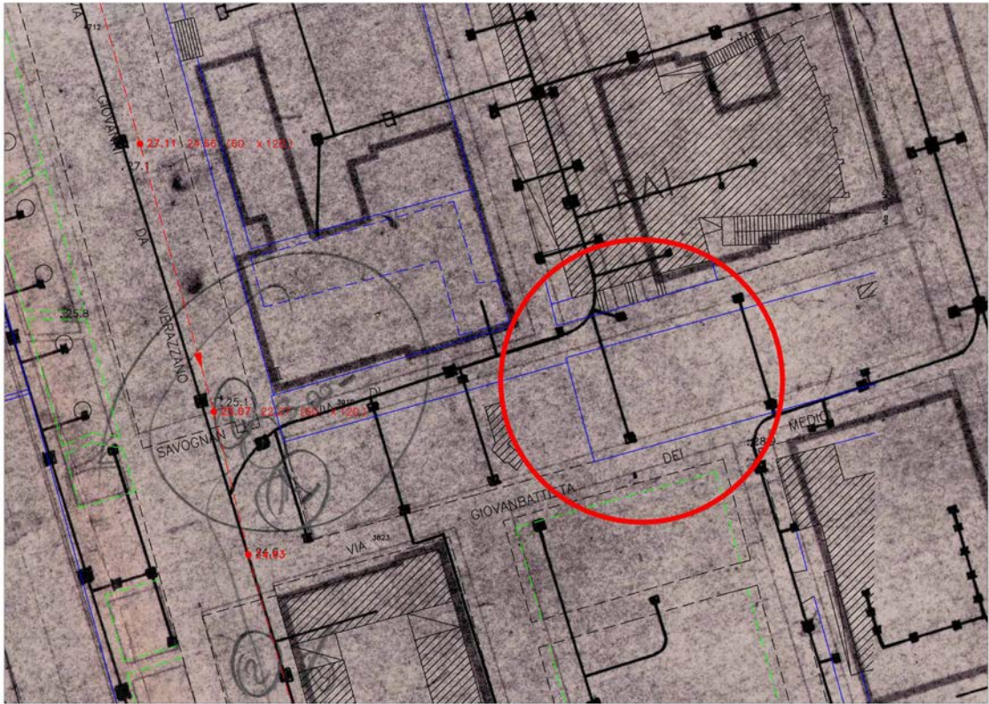
Dettaglio sovrapposizione aerofotogrammetrico con cartografia rete fognaria MdO
